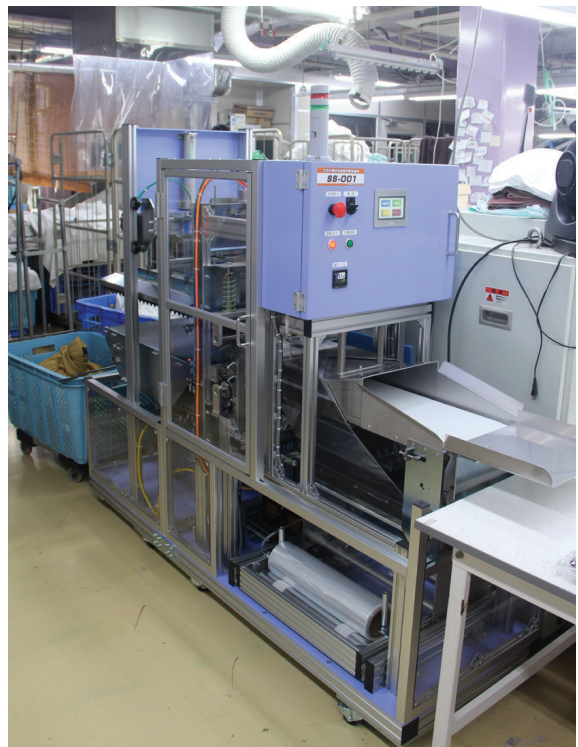
▲今年9月に稼働を始めた全自動包装機SS1001。客先の要望に応え、スポーツジムのタオルやユニフォームを個包装する
